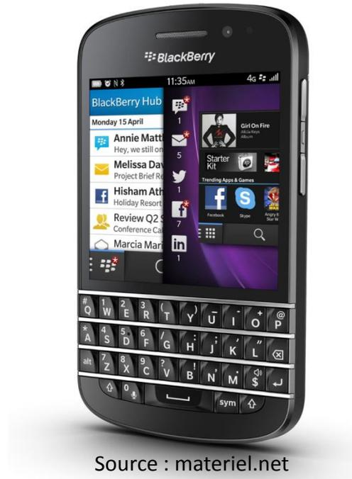
Ce type de clavier présente l'avantage d'être plus précis, et ne rajoute pas d'épaisseur et de poids au téléphone. Néanmoins le clavier intégré réduit la taille de l'écran, ce qui rend la navigation moins confortable.
